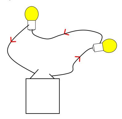
Si une des ampoules grille (ou si elle manque), le circuit est ouvert, les autres ampoules ne fonctionnent plus non plus.
