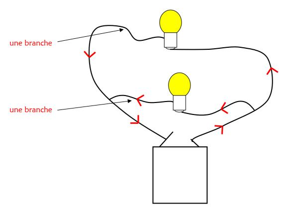
Dans un circuit en dérivation, si une ampoule grille, le circuit reste fermé, les autres ampoules continuent donc de fonctionner.
