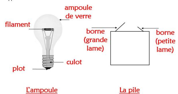
Pour que l'ampoule brille, il faut que le culot soit en contact avec l'une des bornes de la pile (petite lame ou grande lame) et le plot avec l'autre borne de la pile.
